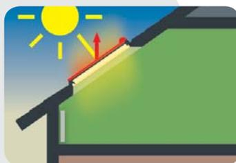
*Gli accessori esterni contribuiscono ad una efficace riduzione del calore solare. Riducono l'azione dei raggi solari prima del vetro, abbattendo in questo modo il flusso di calore e impedendo un veloce surriscaldamento della mansarda.*
