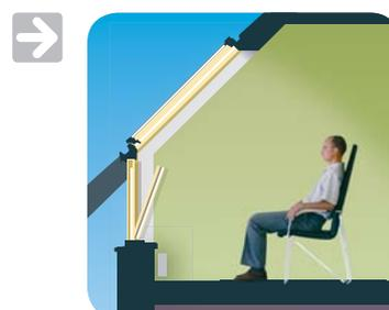
**Finestra ad angolo** è una finestra da installare in verticale direttamente sotto la finestra da tetto (ad angolo). Questa finestra può essere abbinata a qualsiasi modello di finestra da tetto. Una soluzione che permette di aumentare la luminosità nel vano e di ampliare la visibilità verso l'esterno.
