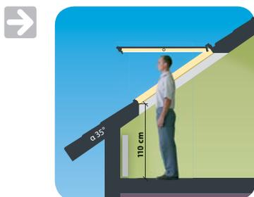
**Finestra a doppia apertura** l'innovativa costruzione delle cerniere garantisce una semplice e comoda gestione della finestra. Le soluzioni di alto livello tecnologico adottate permettono di aumentare la luminosità e di ampliare la visibilità attraverso l'anta aperta. La funzione a bilico permette la rotazione del battente, rendendo così più agevole la pulizia della parte esterna della finestra, come anche il montaggio della tenda ombreggiata esterna.
