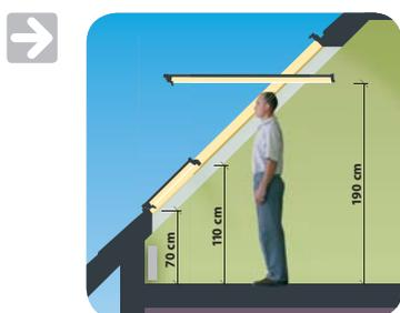
**Finestra con asse di rotazione decentrato ed anta sottoluce** La caratteristica di questa finestra è che su un unico telaio vengono montati due battenti. Il battente superiore è con apertura a bilico e l'asse di rotazione posizionata al di sopra della mezzeria del telaio, mentre il battente inferiore è fisso ed è dotato di un vetrocamera con lastra interna laminata.
