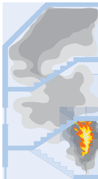
EDIFICIO SENZA SISTEMA DURANTE L'INCENDIO
